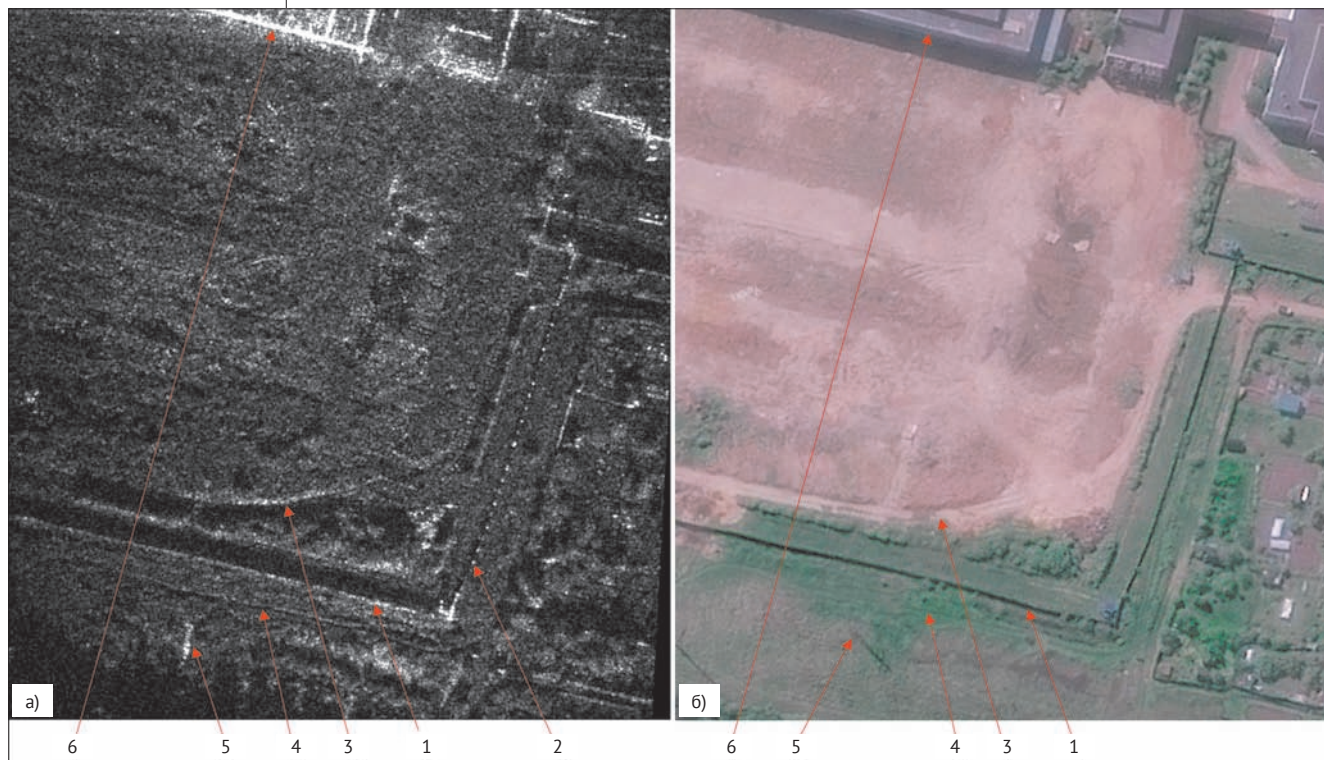
Рисунок 1. РЛИ с разрешением 0.25 м (а) и спутниковый фотоснимок (б) производственной площадки: 1 – ограждение; 2 – столбы ограждения; 3 – следы автомобиля на грунте; 4 – тропа; 5 – опора ЛЭП; 6 – здание
