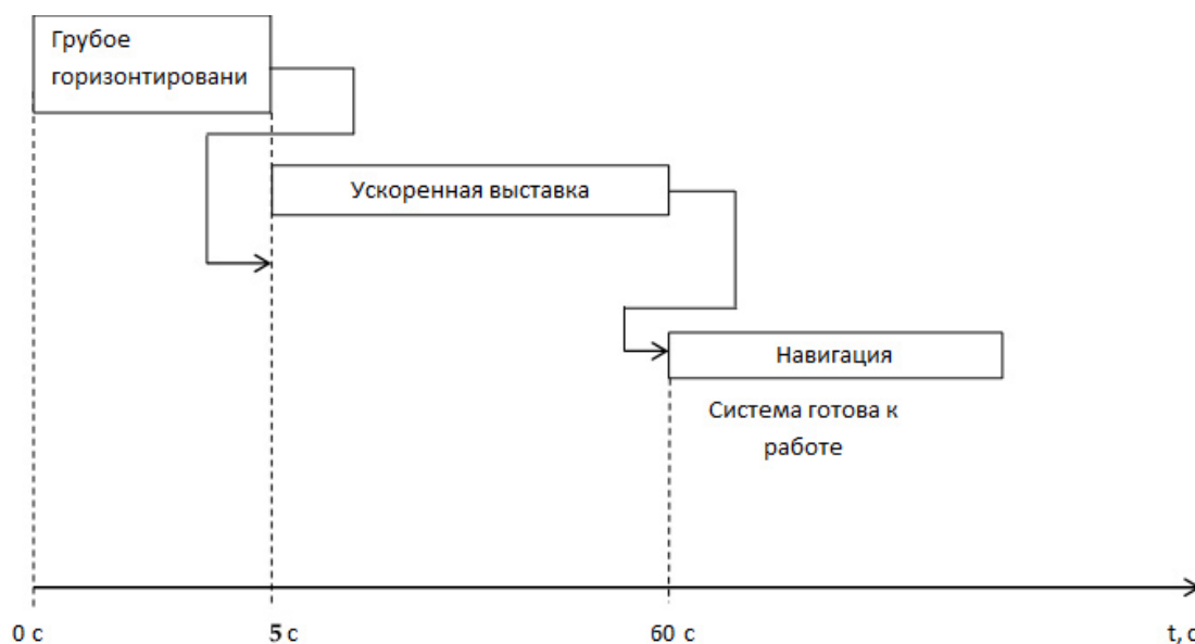
Рисунок 6 — Циклограмма работы системы в момент включения
