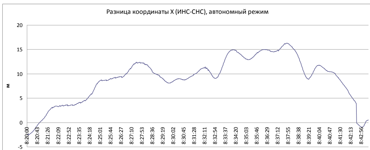
Рисунок 13 – Рассогласование БИНС и СНС по координате X (автономный режим)
