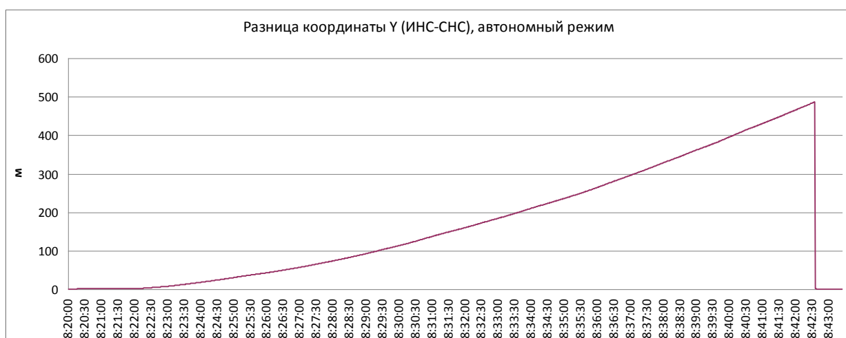
Рисунок 14 – Рассогласование БИНС и СНС по координате Y (автономный режим)
