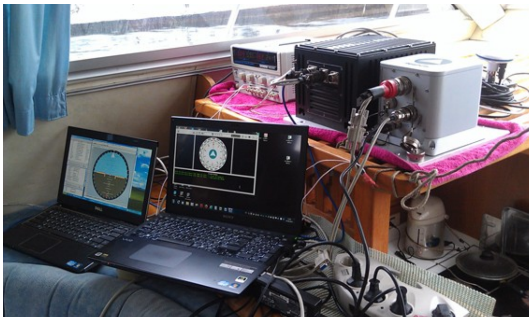
Рисунок 7 – Расположение аппаратуры макета инерциальной навигационной системы АНПА на базе БИНС GL-1000 в помещении катера РПР-2538
