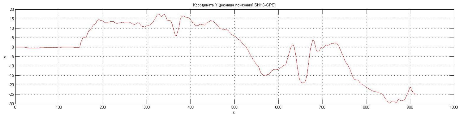
Рисунок 29. Участок 3. Разница координат БИНС-СНС. Автономный режим.
