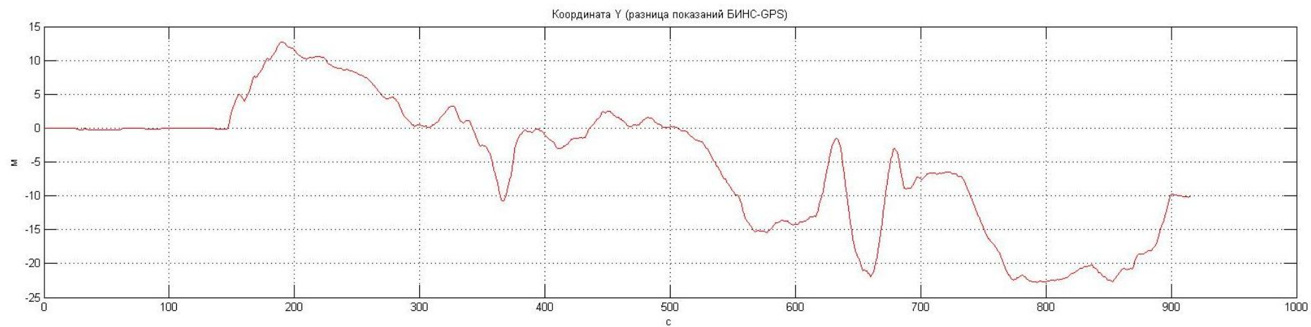
Рисунок 30. Участок 3. Разница координат БИНС-СНС. ДПП включён.
