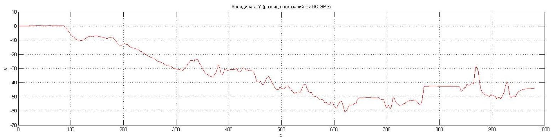
Рисунок 34. Участок 4. Разница координат БИНС-СНС. Автономный режим.
